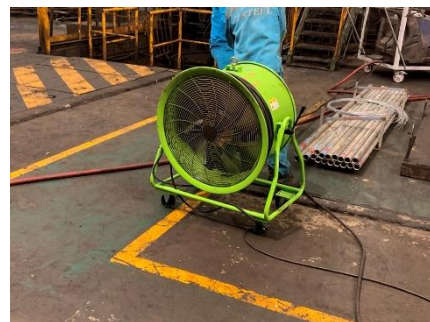
ภาพที่ 3.2.6.3-4 การติดตั้งพัดลมสำหรับระบายอากาศ
